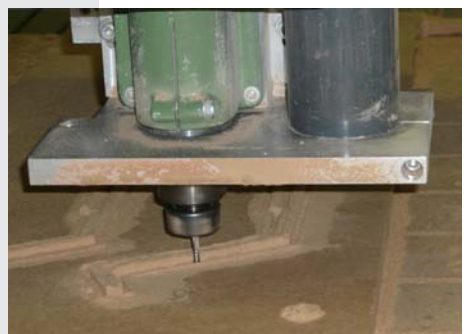
Procédé de prototypage rapide par Stratoconception ©
